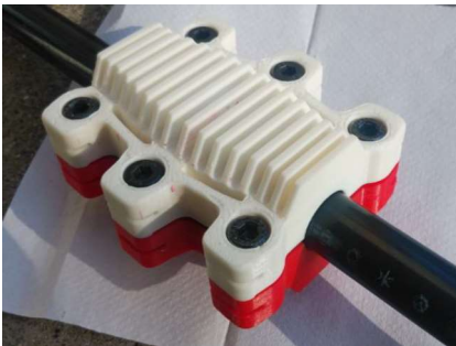
(b) 基本案Eで0.5 MPa 1分間の止水成功 (2024年7月中旬)
