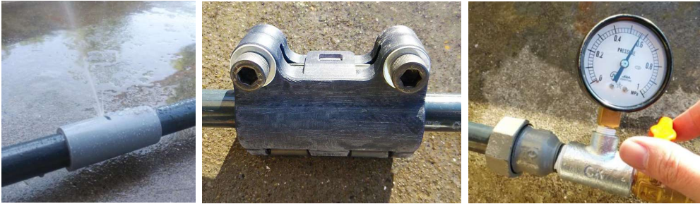
(a) ヒンジ案Eで0.5 MPa 1分間の止水初成功 (2023年12月下旬)
